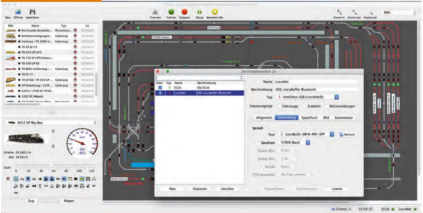
iTrain 5 unter MAC OS X mit dem „Verbindungs“-Dialog im Vordergrund: Die ECoS ist bereits als erste Zentrale konfiguriert. Hier wird gerade der LocoBuffer als weitere Zentrale hinzugefügt. Das interne Protokoll entspricht dabei dem einer Intellibox.
