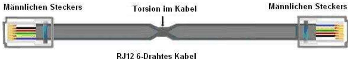
Hier sehen Sie das Kabel, das wir Sie oben gezeigt haben. Sie werden also bemerken, dass wir, um die Lagebestimmung „Pinne-1 bis Pinne 1“ zu halten, eine Torsion in das Kabel einsetzen müssen. Was wir eigentlich tun, ist einfach der männlichen Stecker mit dem hervorspringenden Stück an der Obenseite des Kabels quetschverbinden, und den anderen männlichen Stecker mit dem hervorspringenden Stück an der Unterseite des Kabels quetschverbinden. In der Digitrax Anleitung finden Sie dieses Bild.
