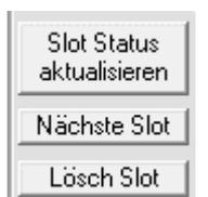
Mit dem Taste "Slot-Status aktualisieren" können Sie den Zustand des zentralen Abfragen, wenn diese Einstellungen von der LocoCentral-Tastatur oder eine andere Software geändert werden und nicht den LocoHDL entsprechen.
