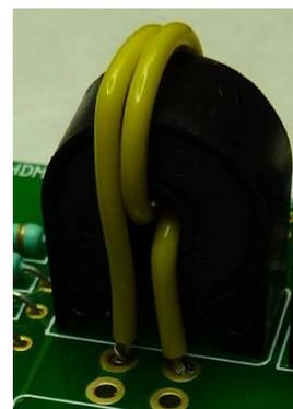
Astuce pour transformateur de capteur de courant
