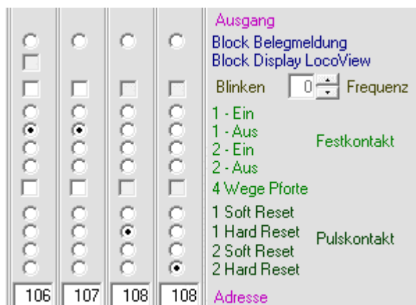
1 Bi-stabile Relais und 2 mono stabile Relais.
