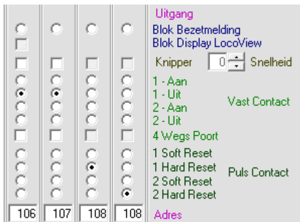
1 Bipolaire relais en 2 mono stabiele relais.
